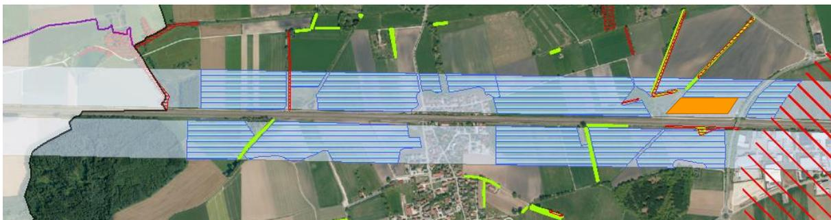
Abbildung 30: Potenzialflächen (blau schraffiert) an der Bahnlinie westlich der Ortschaft Maisach mit Markierung des Zentrums der PV-Bestandsanlage (orange Flächenmarkierung) an der Bahnstrecke.
