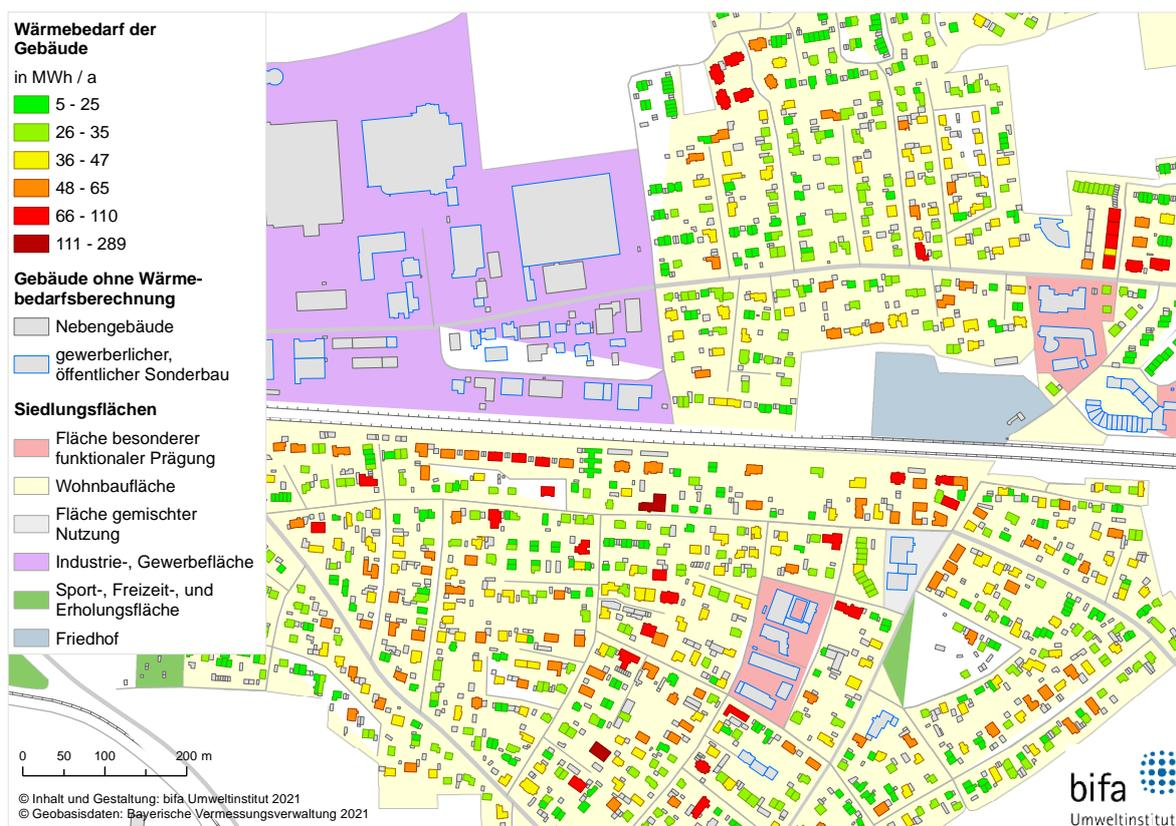
Abbildung 13: Wärmekataster: Wärmebedarf der Gebäude. Detailsicht Gernlinden
